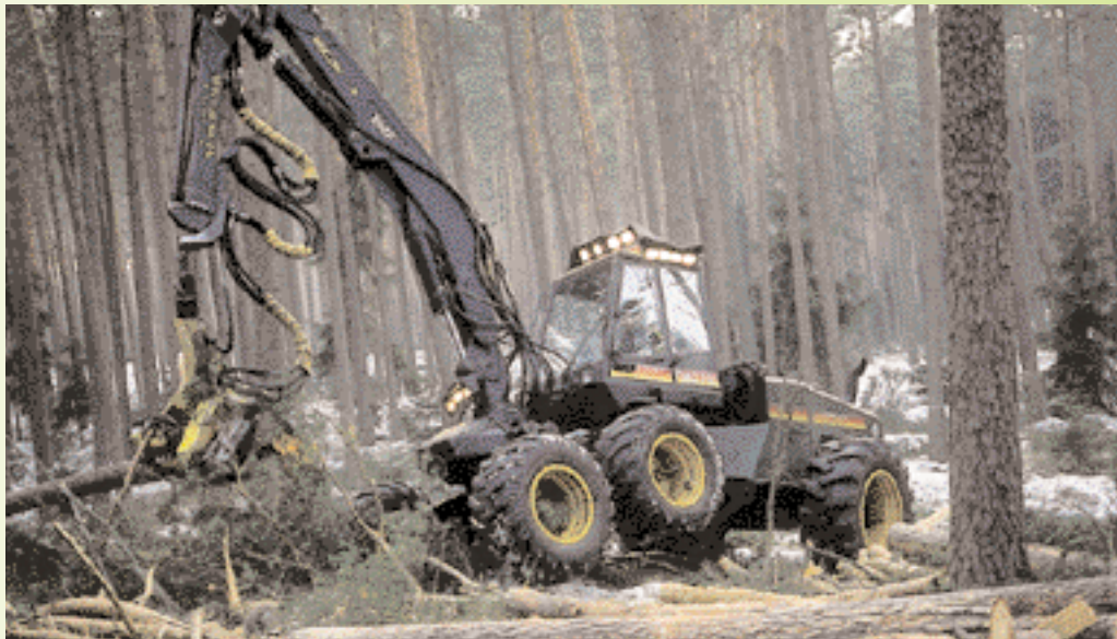
Harvester – maszyna wielooperacyjna do ścinania drzew, okrzesywania oraz przerzynki
