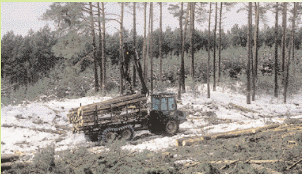
Forwardery, służące do zrywki i transportu drewna, wyposażone są w żurawie hydrauliczne i przyczepy
