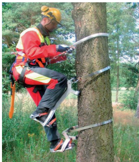
Ryc. 17. Sposób wchodzenia za pomocą drzewołazów bezkolcowych Baumvello (źródło: https://www.wilde.sk/das-baumsteiggerat-baumvelo-lange-1-9-m-fur-65-cm-produkt )
