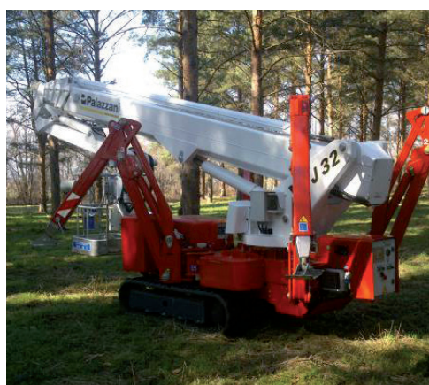
Ryc. 15a i b. Gąsienicowy podnośnik teleskopowy Ragno XTJ32 firmy Palazzani, wykorzystywany do zbioru nasion na plantacjach nasiennych w RDLP Toruń (fot. M. Kuss)
