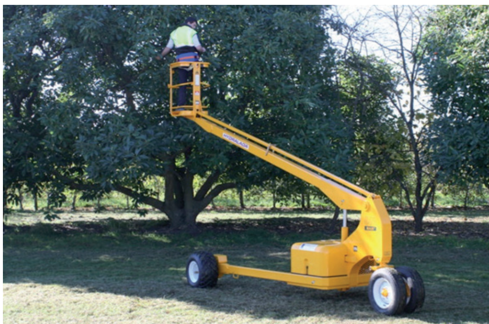
Ryc. 13. Lekki trzykołowy podnośnik Hydralada (z lewej: https://www.dte-equipment.com.au ) oraz Afron (z prawej: https://pl.pinterest.com/ )
