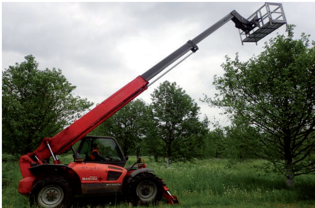
Ryc. 14. Czterokołowy podnośnik teleskopowy Manitou MT 1435 SL, wykorzystywany do zbioru nasion na plantacjach nasiennych w Nadleśnictwie Pniewy (fot. J. Banach)
