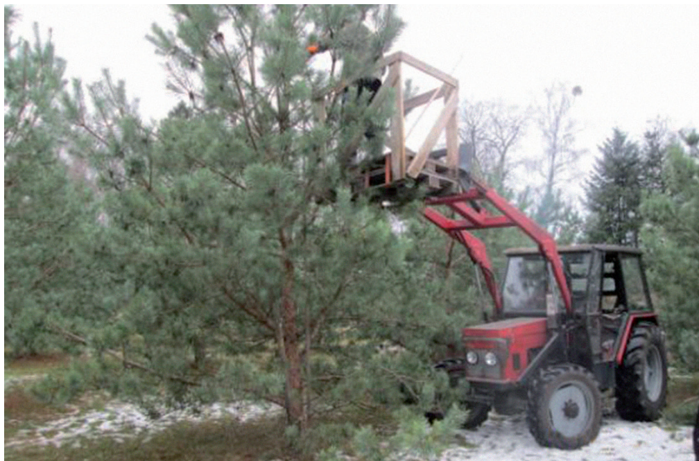
Ryc. 12. Podnośnik widłowy z domontowanym koszem, wykorzystywany do zbioru nasion na plantacji nasiennej sosny zwyczajnej w Nadleśnictwie Szczecinek (fot. R. Obuchowska)
