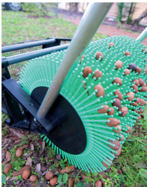
Ryc. 1. Wałek selektywny do zbierania opadłych nasion z ziemi (źródło: https://baganut.com ; https://gardenharvesters.com )
