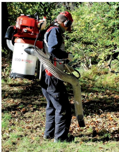
Ryc. 2. Plecakowy aspirator Cifarelli V1200S, którym można zbierać m.in. orzechy i żołądźcie (źródło: Losavio 2014)
