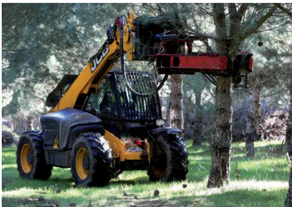
Ryc. 10. Otrząsacz samojezdny do strącania szyszek z drzewa stojącego (źródło: Kitt 2017)
