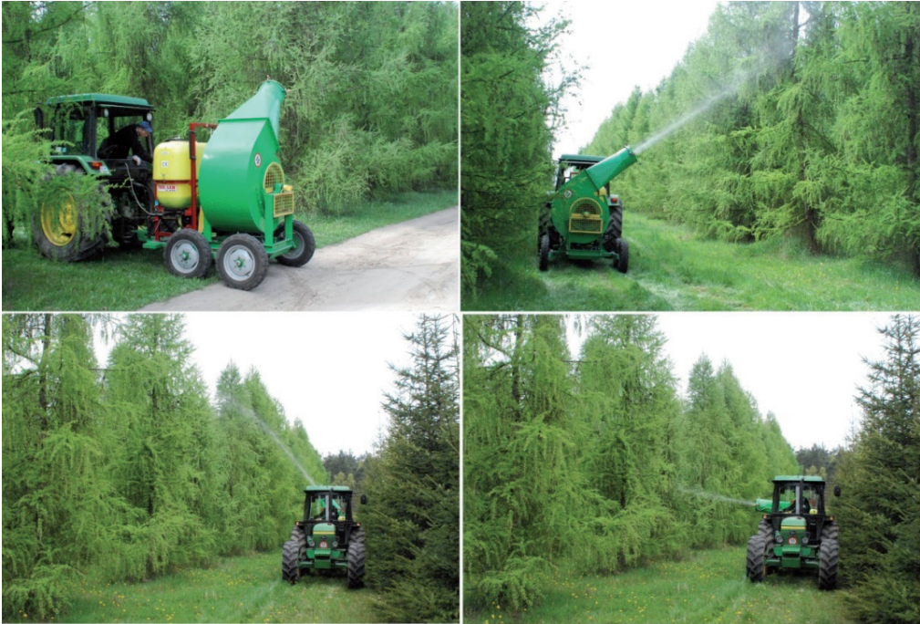
Ryc. 1. Zwalczanie śmietek opryskiwaczem do drzew wysokich na PUN w Nadl. Brzeziny (2008)
