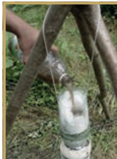
Zanieczyszczoną wodę wlewamy do naczynia-filtru.
