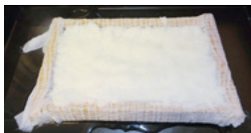
Ramka wypełniona masą pozostawiona do wyschnięcia (S.S.)
