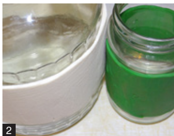
Słoiki o różnych średnicach obłożone jedną warstwą masy plastycznej: widok ogólny (1) i zbliżenie w celu pokazania grubości warstw (2) (S.S.)
